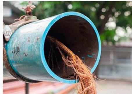
Figura 7: Tubulação obstruída por raízes
