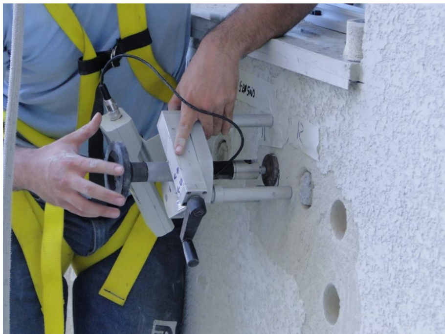
RUPTURA DO CORPO DE PROVA
